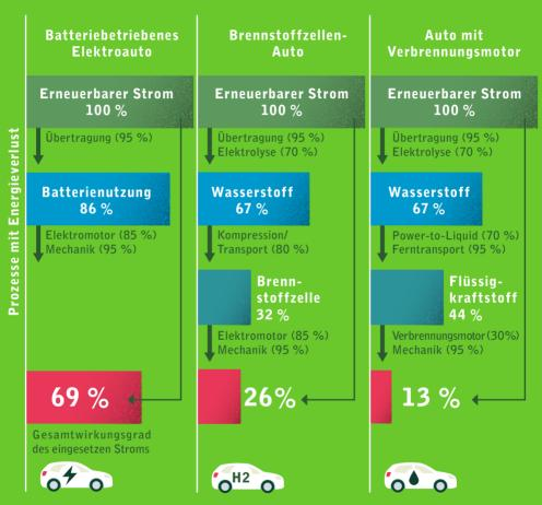
Hinweis: Einzelwirkungsgrade in Klammern. Durch Multiplikation der Einzelwirkungsgrade ergeben sich die kumulierten Gesamtwirkungsgrade in den Kästen
