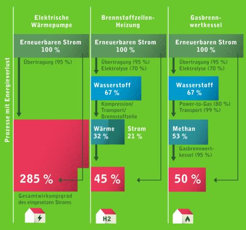
Hinweis: Einzelwirkungsgrade in Klammern. Durch Multiplikation der Einzelwirkungsgrade ergeben sich die kumulierten Gesamtwirkungsgrade in den Kästen. Für die Wärmepumpe wird eine Jahresarbeitszahl von drei angenommen.
